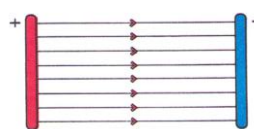
Rovnorodé /homogénne/elektrické pole
