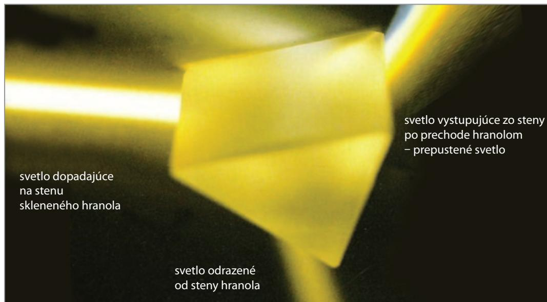
Obr. 11 Správanie svetla dopadajúceho na sklenený hranol
