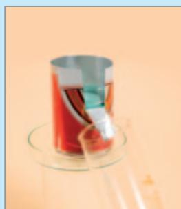
Obr. 87 Objem vody vytlačenej telesom
