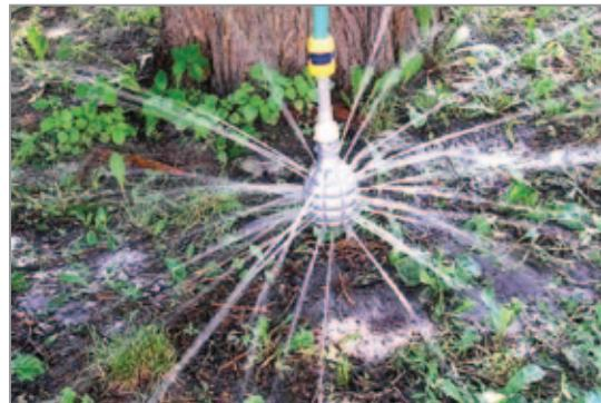
Obr. 92 Pôsobenie tlakovej sily v kvapalinách
