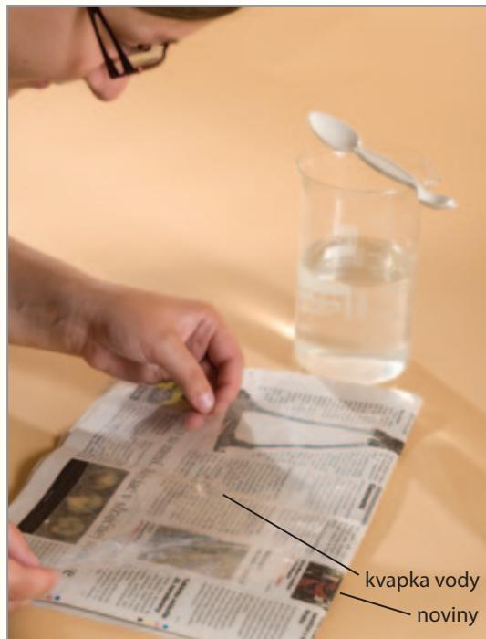
Obr. 3 Pozorovanie písmen pomocou kvapky vody
